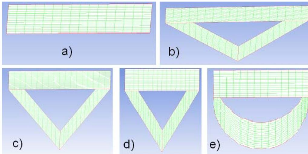
**Figure 3** a) Flat plate b) 120° v-hull c) 90° v-hull d) 60° v-hull e) convex hull.
